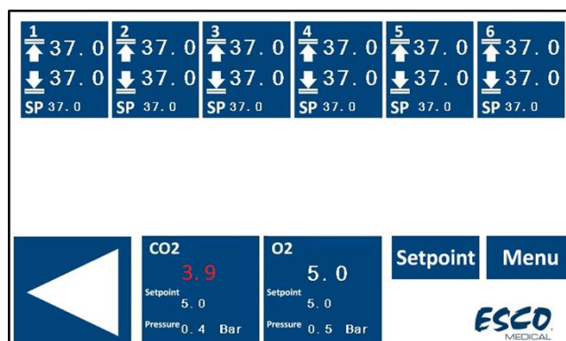
Figura 14.5 Vista dell'allarme di bassa concentrazione di CO 2 sulla schermata principale dell'incubatore multicamera IVF MIRI® TL6
