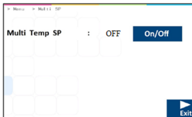
Figura 13.27 Schermata del setpoint di temperatura multiplo negli incubatori multicamera IVF MIRI® TL6 e MIRI® TL12
