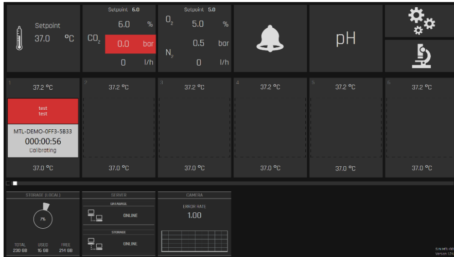
Figura 20.39 Visualizzazione dell'allarme di pressione della CO 2
